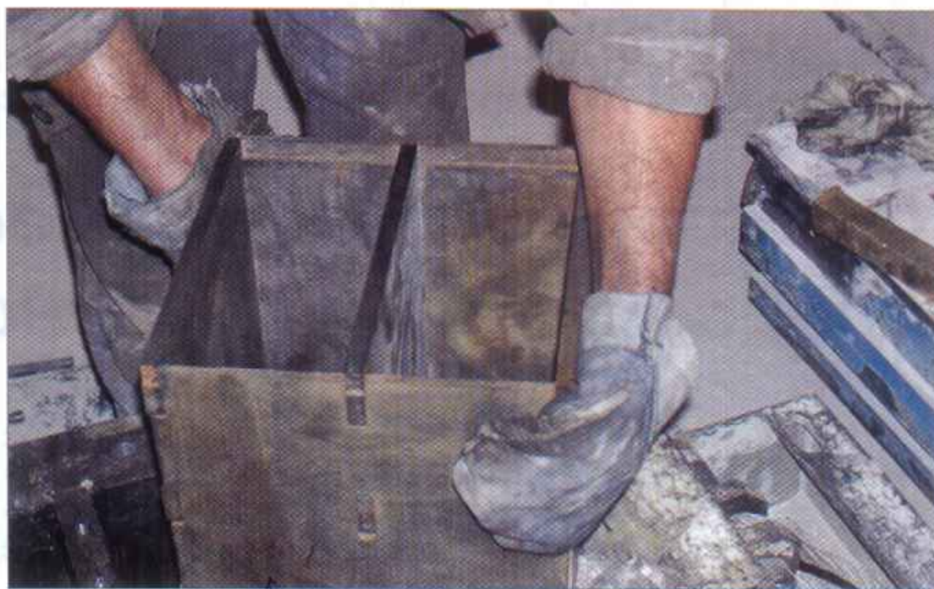
Сборка пресс-форм с пластинами «ВИЗО» при производстве кирпича производится без применения дополнительной оснастки
