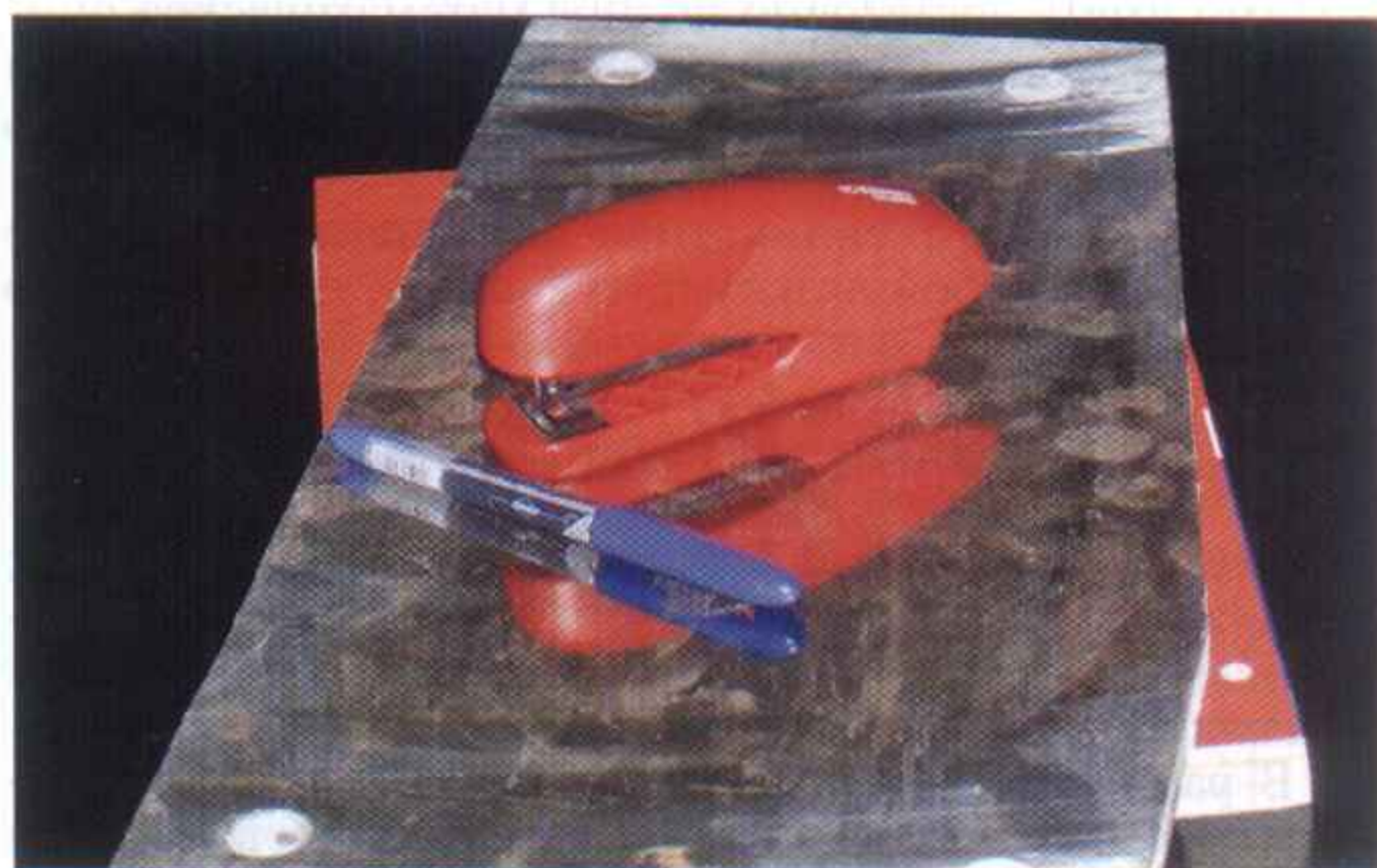
Износостойкие пластины «ВИЗО» после воздействия силикатной массы
